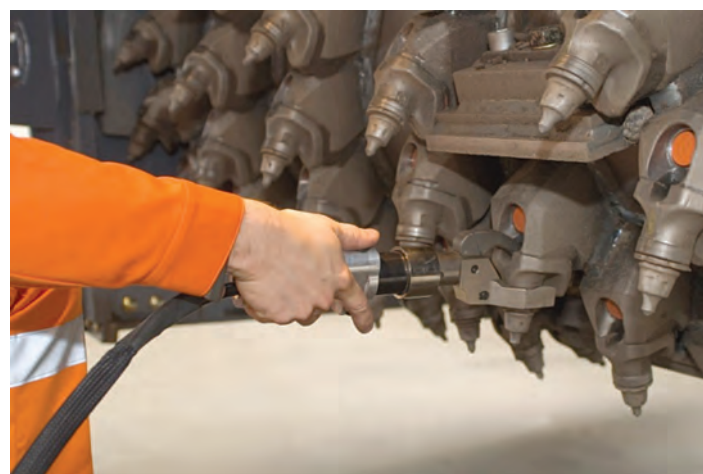
Extractorul de scule tăietoare asistat hidraulic al Wirtgen este conectat direct la sistemul hidraulic al utilajului
