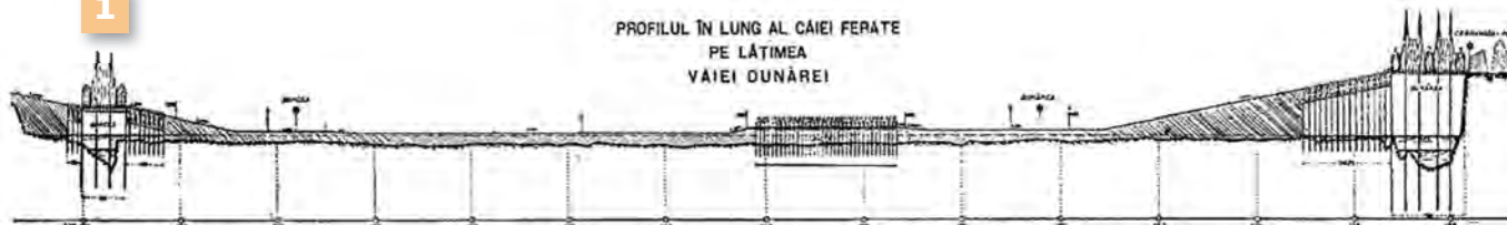
Fig. 108 - 1. Profilul în lung al căii ferate pe lățimea albiei majore a fluviului Dunărea; 2. Elevația amonte a deschiderii independente de la Podul Dunărea, cu dorobanțul de la Portalul culeii Cernavodă (Desen N. POPESCU)
