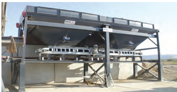
Foto B - Dozatoare material granulat dotate cu extractoare cu bandă
