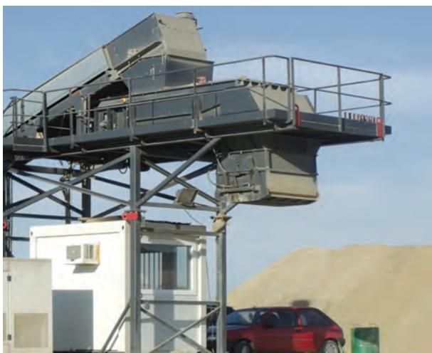
Foto C - Introducerea apei în a doua parte a malaxorului
