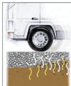
Figura 1 Fundație fără geotextil
