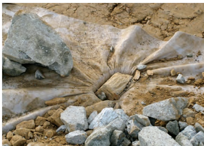
Figura. 4 Geotextil așezat pe un sol slab - TenCate Polyfelt TS
