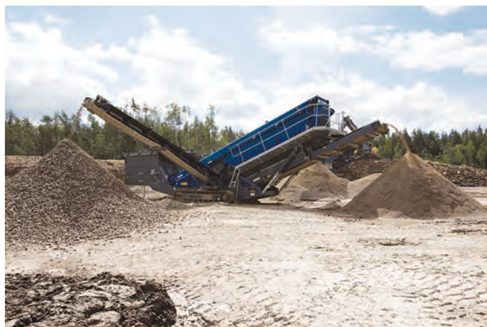
Mobiscreen MS 19 Z: Poate fi utilizat în aplicații cu piatră naturală și în reciclare, având o capacitate de până la 500 t/h
