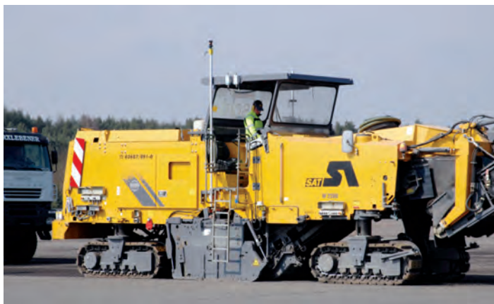
Fig. 5 Deasupra celui mai jos punct al tamburului de frezare se află catargul cu prismă. Pe copertină, deasupra cabinei operatorului, se află dispozitivele radio care primesc semnalele de la tahometru și sunt conectate la computerul de sistem.
