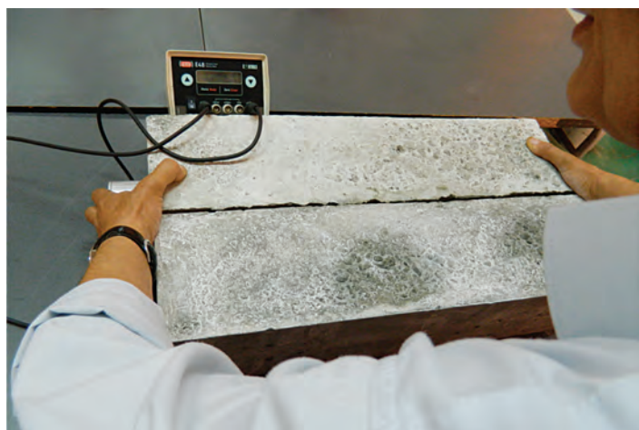
Figura nr. 3 – determinarea vitezei ultrasonice pe epruvete prismatice
