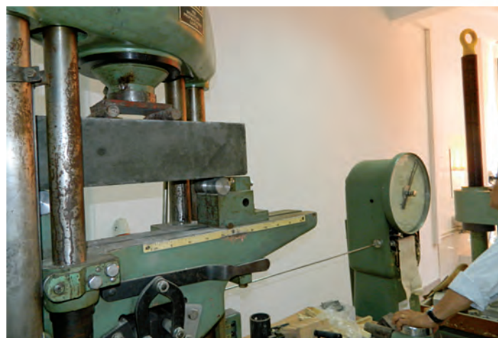
Figura nr. 4 – determinarea rezistenței la încovoiere pe epruvete prismatice
