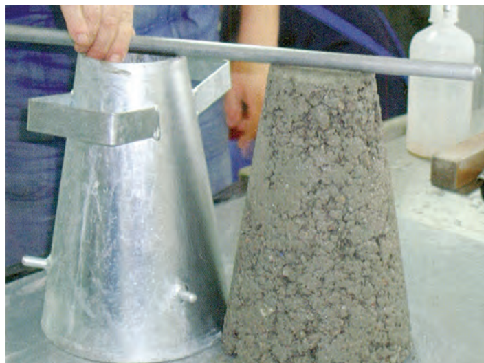
Figura nr. 2 – consistența betonului prin metoda tasării
