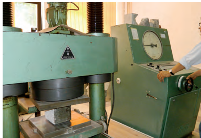
Figura nr. 5 – determinarea rezistenței la compresiune
