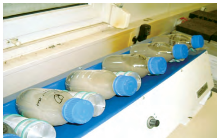
Fig. 6 Echipament pentru testul prin rostogolire, conform EN 12697-11A
