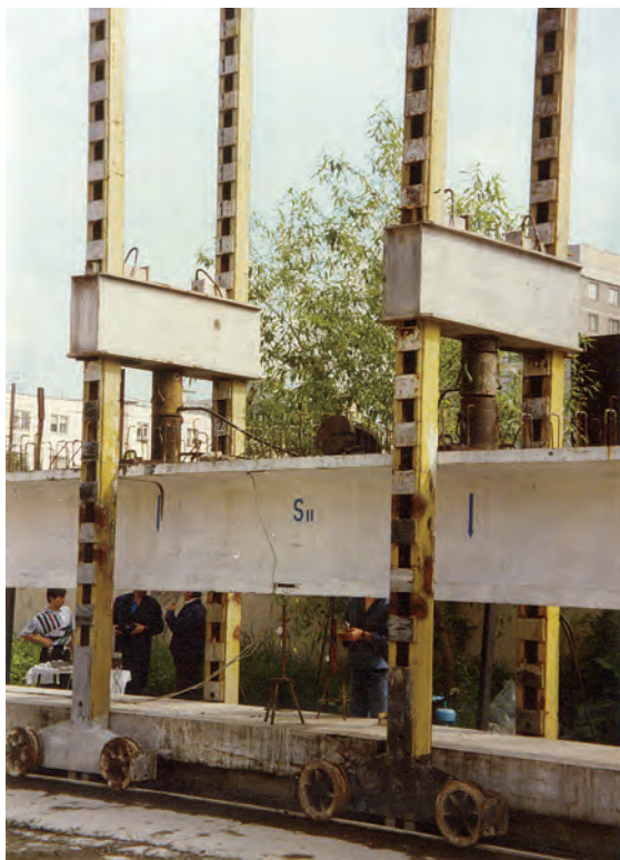
Încercare la rupere pe stand a unei grinzi cu armătură preîntinsă (la Brașov).
