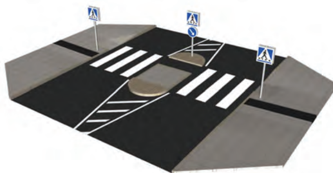
Fig. 5. Facilități de traversare pentru pietoni [5]
