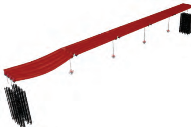
Figura 9 – Forma deformată a structurii în urma aplicării schemei 1 de încărcare
