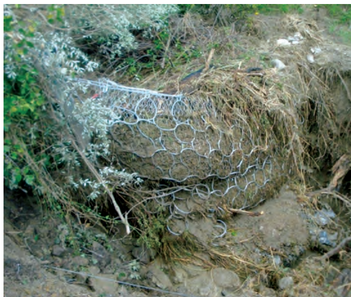
Foto 2: Bariera flexibilă MACCAFERRI OM CTR DF, umplută pe durata testării
