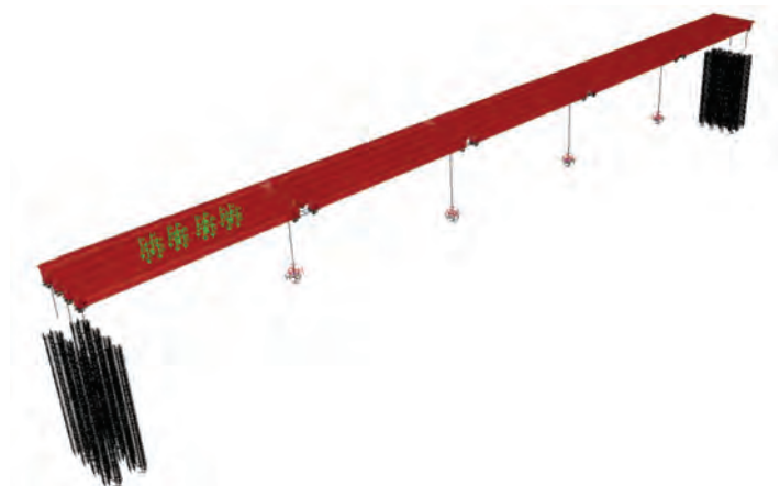
Figura 8 – Modelarea încărcării conform schemei 1 de încărcare, în deschiderea 1
