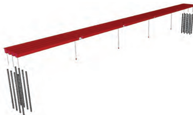
Figura 4 – Modelul tridimensional cu elemente finite al viaductului
