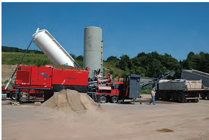
Foto 1. Instalație mobilă de preparare mixturi reci WIRTGEN KMA 220
