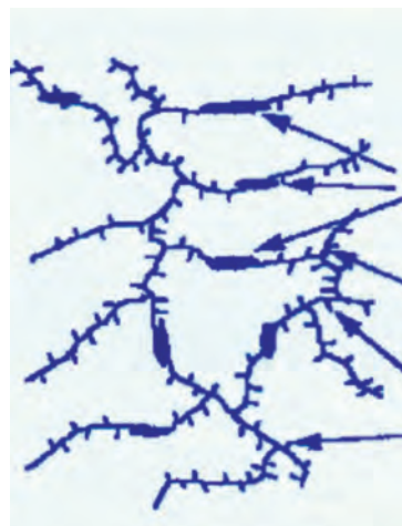
Fig. 3. Représentarea schematică a unui plastomer
