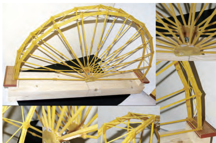
Fig. 17. Modelul (M1) executat din paste făinoase și care a fost supus testării
