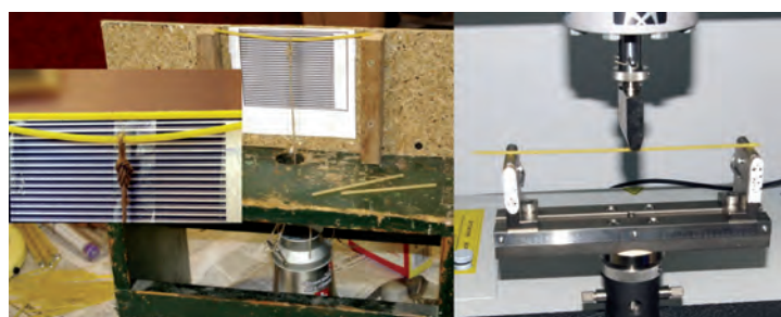
Fig. 9. Încercarea la încovoiere în varianta mai puțin pretențioasă (stânga) și cu o metodă precisă (dreapta)
