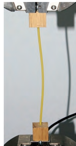
Fig. 7. Încercarea la flambaj
