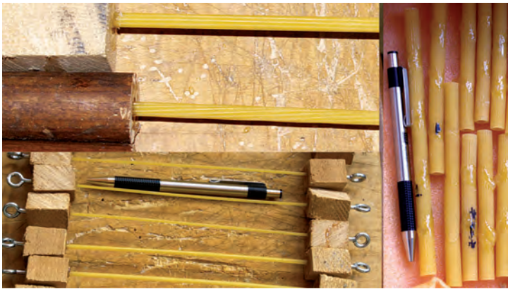
Fig. 5. Elemente întinse (stânga) respectiv comprimate (dreapta)
