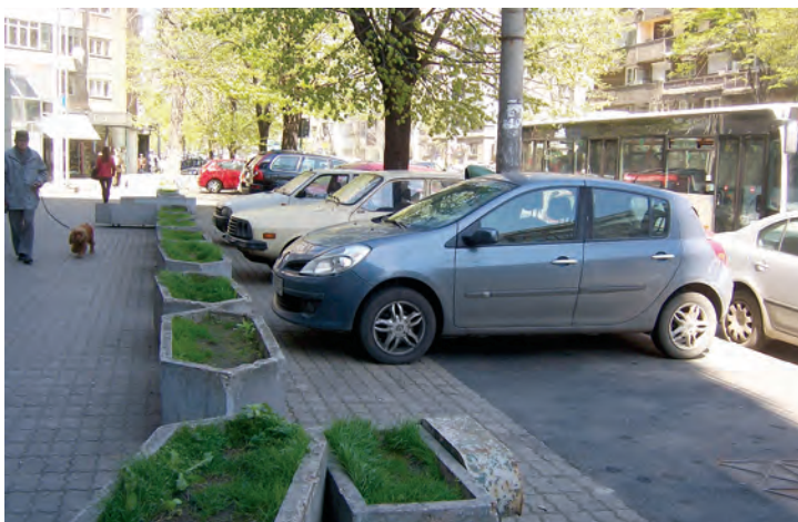
Foto 3 - Lățimea trotuarului depășește cu mult pe cea necesară traficului pietonal. Parcarea dezordonată (a se vedea planul îndepărtat) reduce substanțial capacitatea de parcare a suprafeței disponibile.
