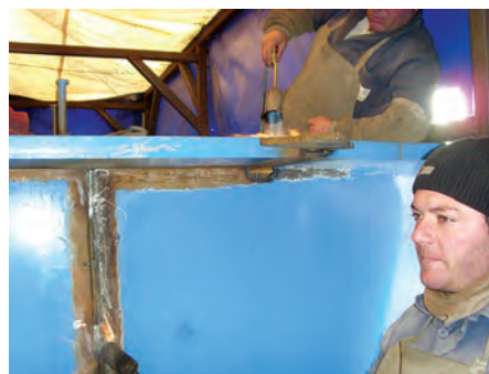
Fig. 16 Preîncălzire cu flacăra gaz-aer
