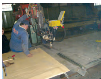
Fig. 20 Sudare cu arc electric cu sârmă electrod sub strat de flux
