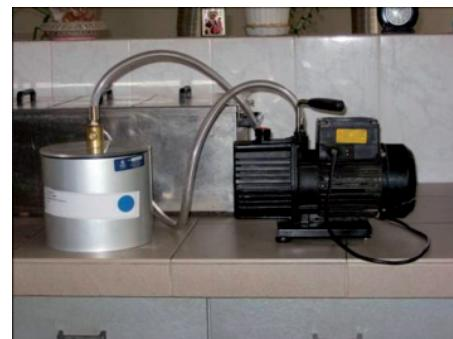
**Picnometru pentru densitate maximă a mixturii**
