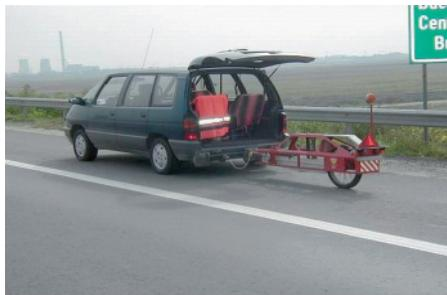
**Analizorul de profil longitudinal APL72**
