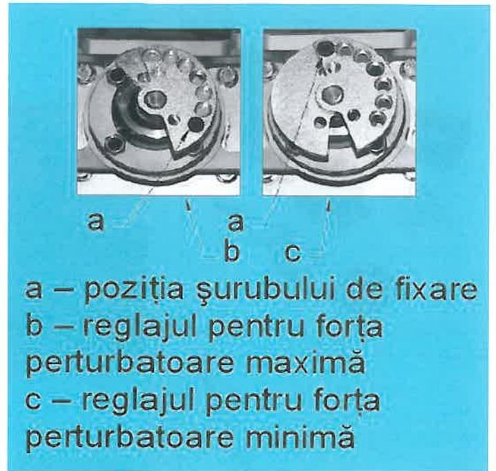
a – poziția șurubului de fixare
