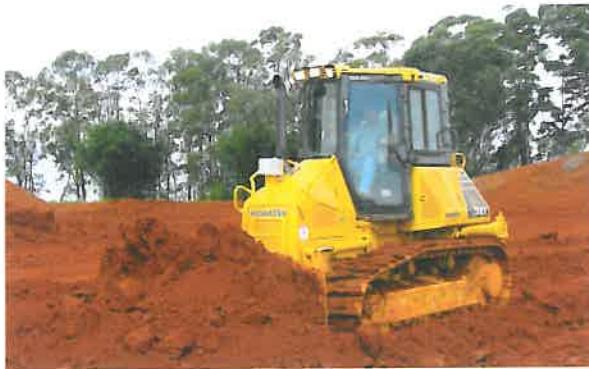
Gratie trasaturilor unice ale buldozerului D51EX/PX-22 si ale lamei sale, ai garantia celei mai bune vizibilitati. Cabina sa care integreaza sistemul ROPS si capota tesita a motorului ofera vizibilitate totala a suprafetei de lucru, sporesc precizia eficienta si siguranta.
