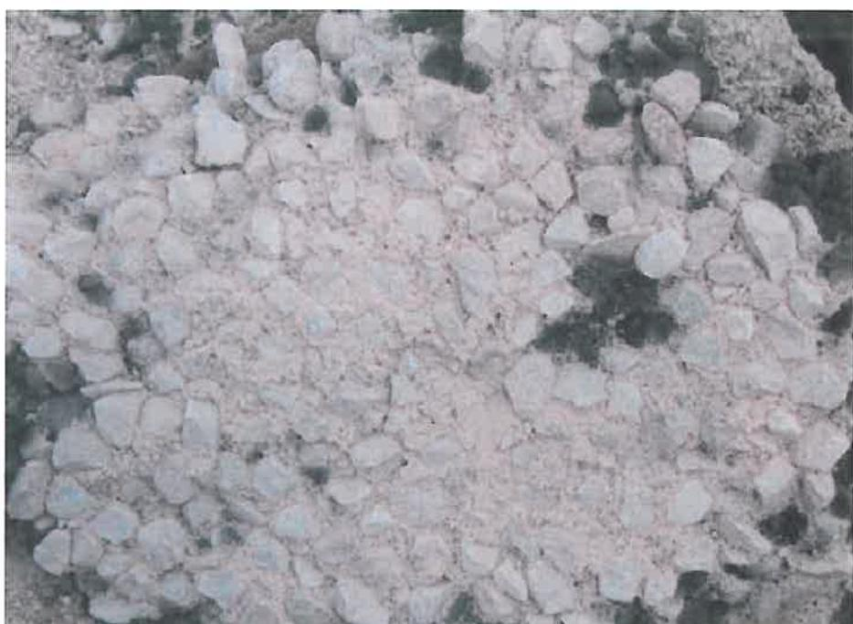
*Fig. 10: Aspectul mixturii bituminoase după ardere (masa de cenușă și agregate)*
