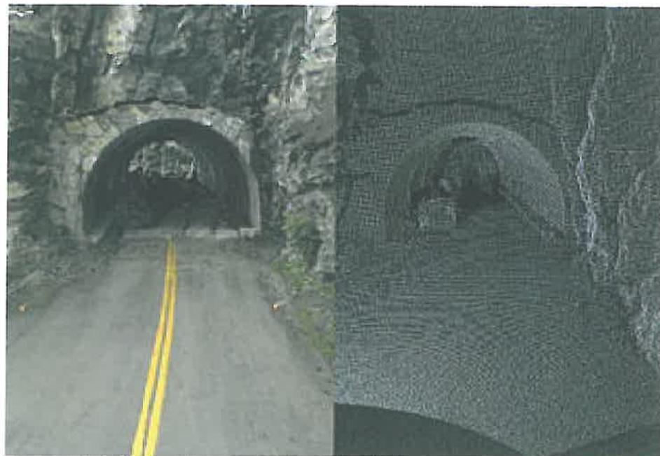
*Cele două vederi pe ecran ale unei secțiuni cu date de imagine color aplicate la puncte; jumătatea stângă a imaginii reprezintă datele imaginii color, jumătatea dreaptă reprezintă imaginea brută în puncte lidar. Scanarea a fost făcută la un Tunelul Portalului de Vest de pe "Drumului care merge după Soare".*
