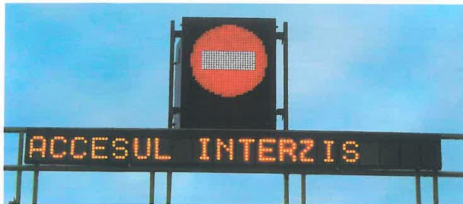
**Fig. 1. Modulul de afişare grafică color și afişare alfa numerică**
