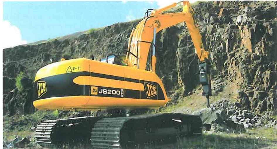
mediu. Motoarele Isuzu Tier III, prezente pe noua gamă de excavatoare JCB, prezintă un regulator la pompa de injecție care permite reglarea automată a puterii motorului, în funcție de tipul operației. Acest sistem electronic prezintă avantaje majore față de sistemele mecanice existente în prezent.
