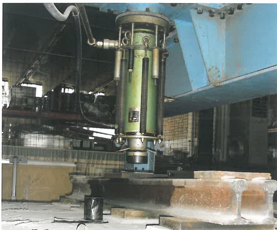
Fig. 3. Stand pentru testarea în regim dinamic a modelelor de poduri la scară mare
