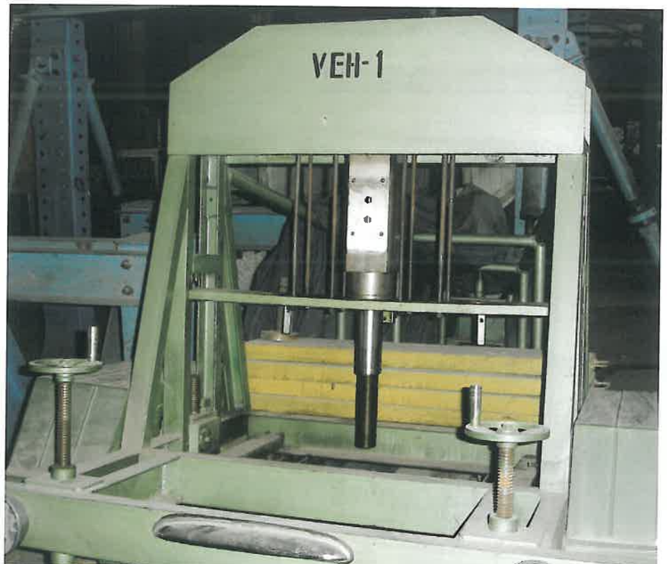
Fig. 1. Vibrator electrohidraulic construit de prof. F. VARLAM și aflat în dotarea Laboratorului de Poduri din Facultatea de Construcții și Instalații din Iași
