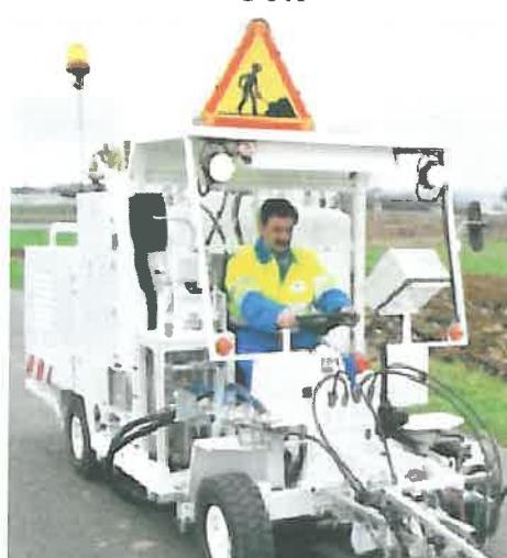
Destinat pentru lucrări de marcaje pe drumurile naționale, drumurile modernizate și autostrăzi. Puterea motorului 55 kW (75 CP). Două roți directoare, 1000 kg de vopsea și 600 kg de bile. Pompă de 27 l/min cu modulator electronic. Deplasare prin autopropulsie. Viteza de realizare a marcajelor cuprinsă între 7 și 12 km/oră
