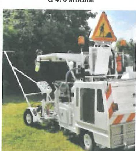
Destinat pentru lucrări de marcaje în orașe și pe drumurile naționale. Puterea motorului 14 kW (19 CP). Două roți direcționale, 150 kg de vopsea și 50 kg de bile. Pompă de 12,5 l/min cu modulator electronic. Deplasare prin autopropulsie. Viteza de realizare a marcajelor cuprinsă între 7 și 10 km/oră.
