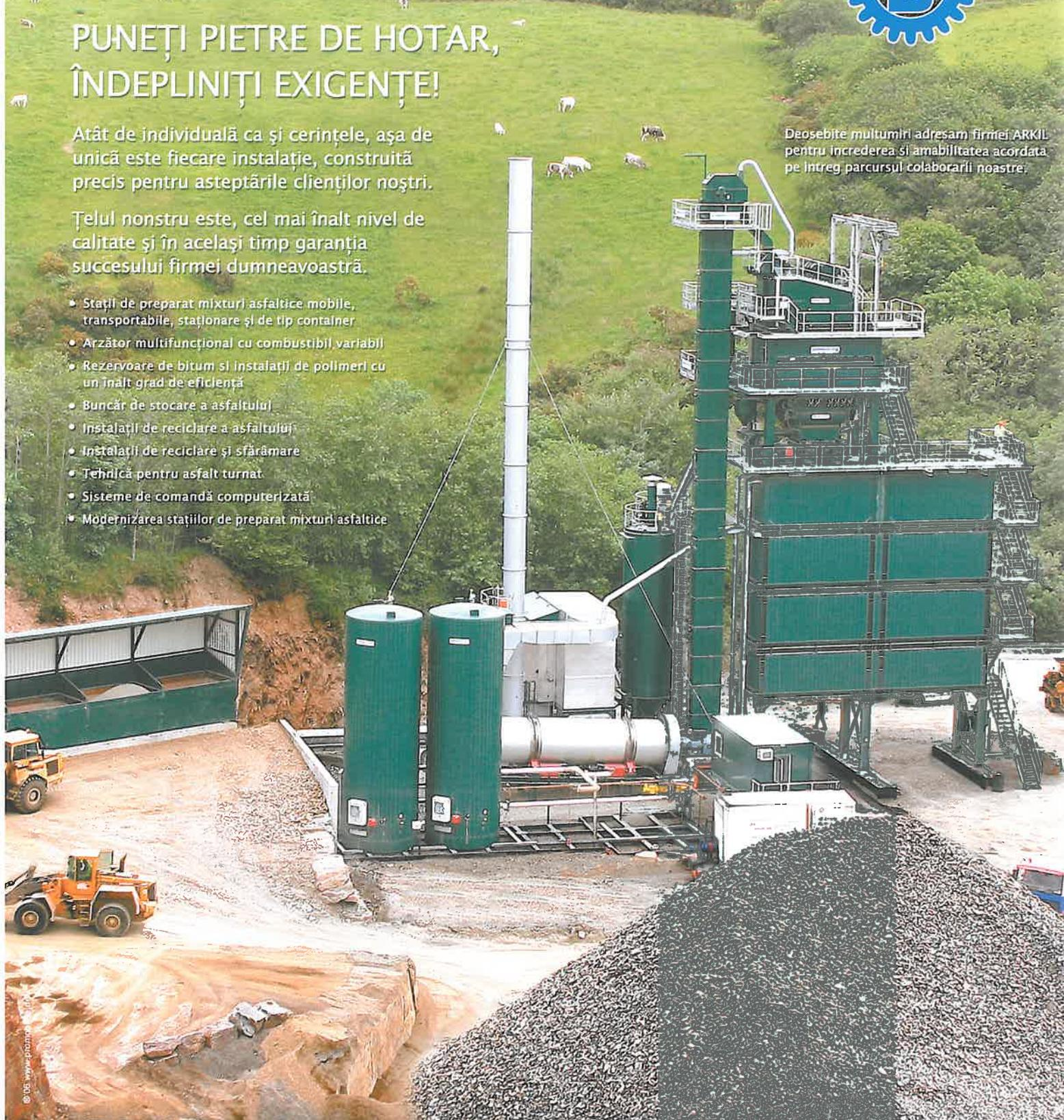
Stație de preparat mixturi asfaltice:
