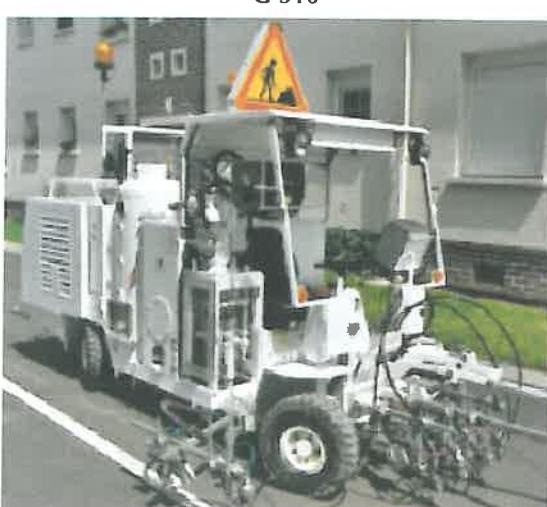
Destinat pentru lucrări de marcaje pe drumurile naționale, drumurile modernizate și marile artere. Puterea motorului 40,5 kW (55 CP). Patru roți directoare, 600 kg de vopsea și 700 kg de bile. Pompă de 25 l/min cu modulator electronic. Deplasare prin autopropulsie. Viteza de realizare a marcajelor cuprinsă între 7 și 16 km/oră
