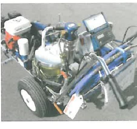
Destinat pentru lucrări de marcaje în orașe și lucrări speciale. Puterea motorului 4 kW (5,5 CP). Masa de 128 kg. Transportabile cu autoutilitare ușoare. Pompă de 7,5 l/min cu modulator electronic. Deplasare prin împingere. Viteza de realizare a marcajelor de 8 km/oră. Posibilitate de atașare a unui sistem de propulsie cu operator purtat între 0 și 10 km/oră. |
