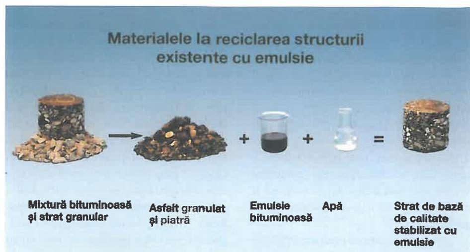
Ilustrat în laborator: material original, aditivi și corp de probă din material final
