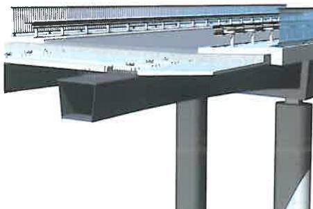
*Fig. 6. Alcătuirea unui pod de șosea în soluție compusă*
