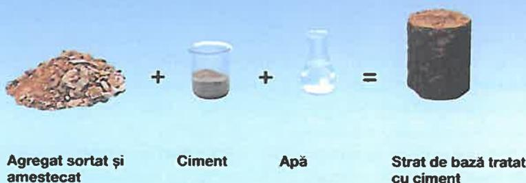
Ilustrat în laborator: material original, liant și corp de probă din materialul procesat
