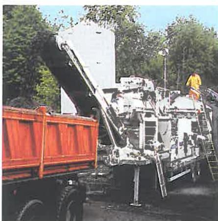
La fiecare 10 min. se umple o basculantă de 20 t cu mixtură produsă în stația KMA 200
