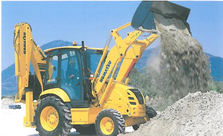
cu un motor turbo KOMATSU de 99,2 CP ce face ca viteza maximă de deplasare să fie de 40 km/h. Capacitatea mare a motorului (4,5 l) asigură o putere și un cuplu excepționale și în același timp motorul respectă normele de poluare 97/68/EC Stage 2. Brațul telescopic împreună cu o gamă largă de atașamente fac ca acest echipament să fie ideal pentru o gamă largă de aplicații.
