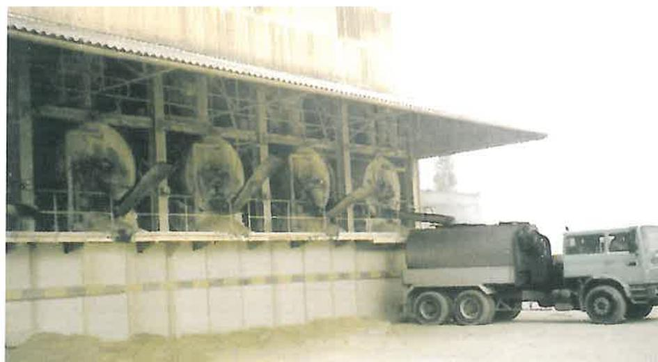
Fig. 5. Malaxor fix pentru fabricarea asfaltului
