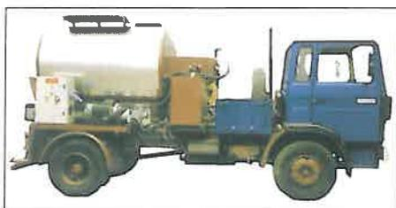
Fig. 2. Malaxor mobil montat pe camion
