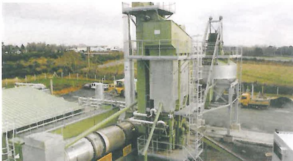
Fig. 6. Malaxor fix pentru fabricarea asfaltului
