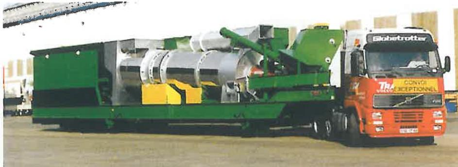
Fig. 7. Instalație mixtă ultramobilă - semiremorca 1
