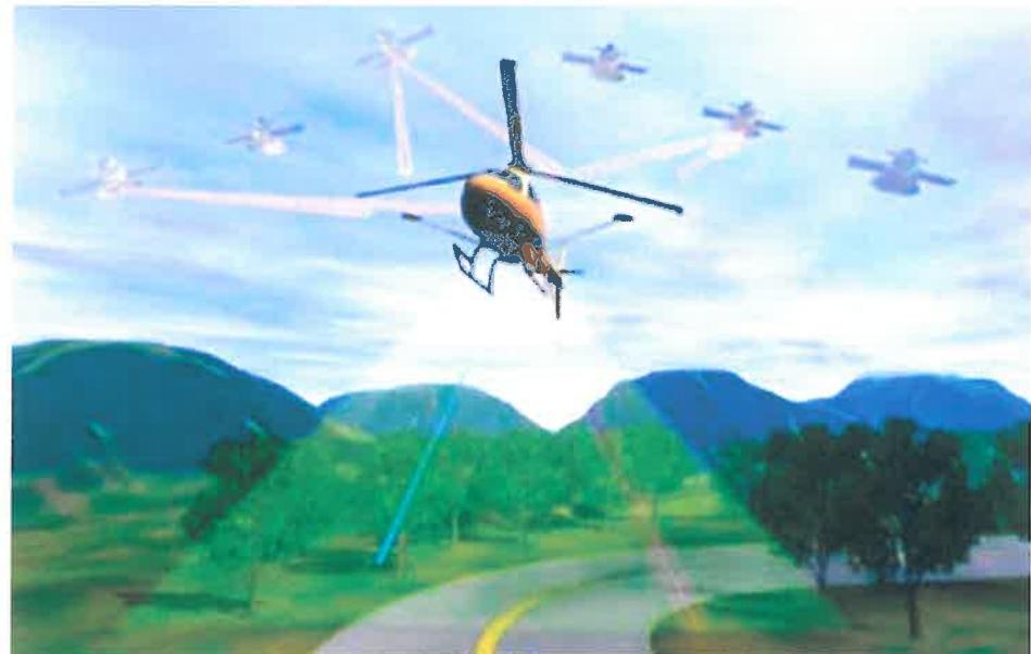
and Mapping Airborne Platform) poate furniza suficientă rezoluție și precizie în survolările din topografia inginerească. Densitatea mare de puncte (10 - 30 puncte/mp), datele extrem de precise ale sistemului împreună cu acoperirea de imagini video a corridorului de zbor, permit cartografierea tuturor datelor ce se află în lungul oricărui corridor survolat. De exemplu, cartografierea unei autostrăzi, poate fi făcută până la cel mai mic detaliu, inclusiv semnele de circulație, marcajele
