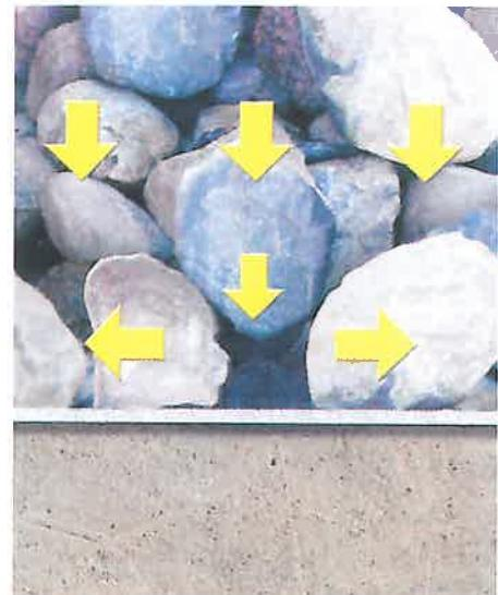
În lipsa unui strat de separație între materialul granular din fundația unui drum și terenul de fundație va avea loc contaminarea materialului granular cu particule de praf și argilă care vor „urca” din stratul suport prin pompaj. Pe de altă parte, atunci când execuția drumului se face pe timp ploios, în lipsa unui strat de separare, materialul granular se va amesteca din start cu praful și argila existentă de data asta sub
