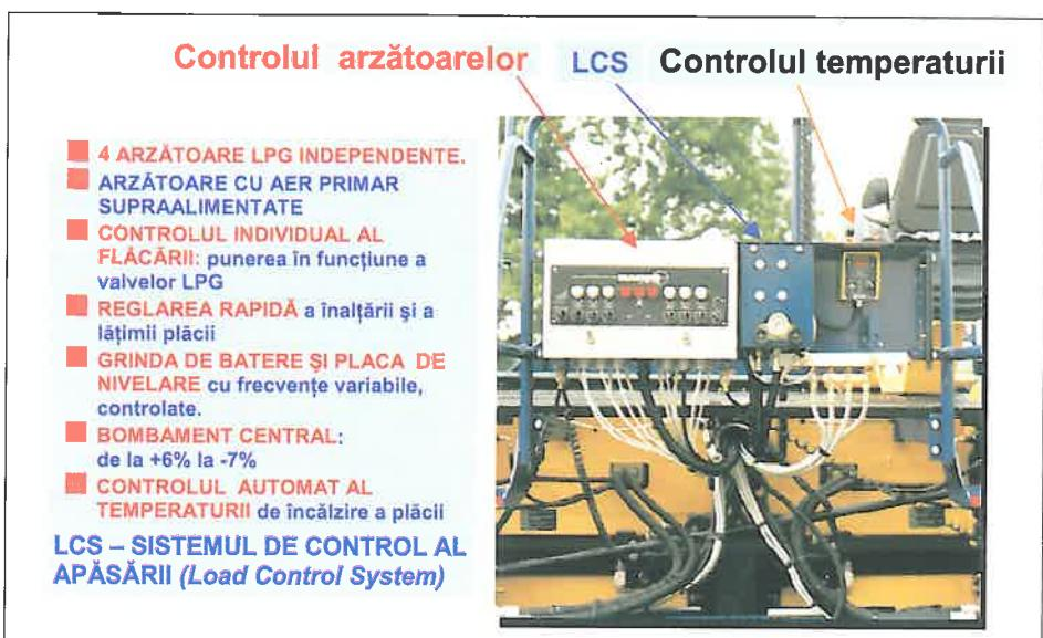
Fig. 4. Placă extensibilă hidraulic tip HC
