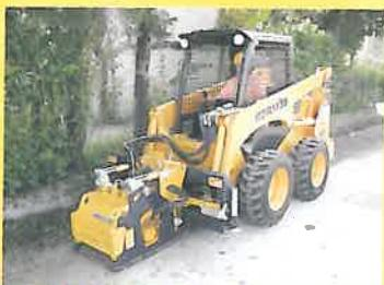
Mini încărcător cu freză de asfalt
