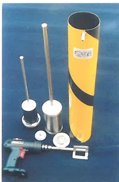
Fig. 3. Umidometru hidrostatic DHD
