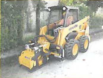
Mini încărcător cu freză de asfalt
