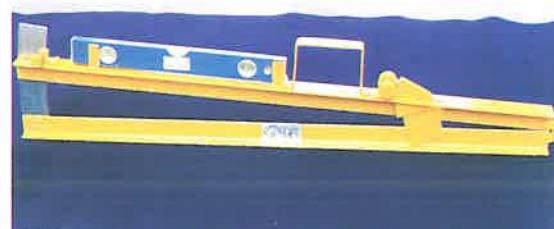
Fig. 7. Pantometre pentru straturi din complexul rutier
