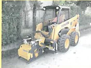
Mini încărcător cu freză de asfalt
