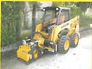
Mini încărcător cu freză de asfalt
