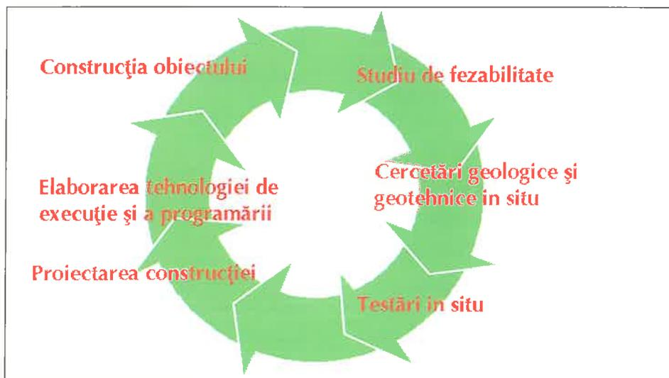
Fig. 1. Ciclul de realizare al unui proiect de construcții
