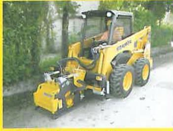
Mini încărcător cu freză de asfalt
