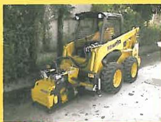
Mini incărcător cu freza de asfalt
