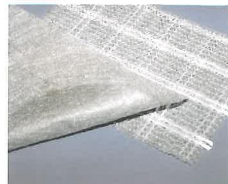
**Polyfelt.PGM 14 este un geotextil din polipropilenă 100%, stabilizată la UV, legat mecanic, cu filament continuu, nețesut**
