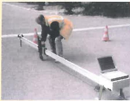
Fig. 3. Transversoprofilograf
