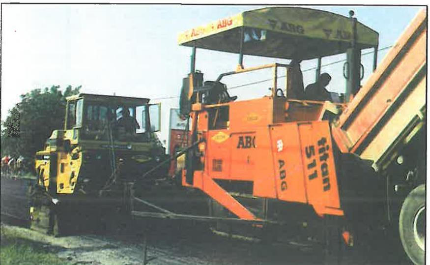
**SOROCAM** execută lucrări de retratate la rece a îmbrăcăminților asfaltice degradate, prin sistemul "NOVACOL" cu utilaje de înaltă performanță.
