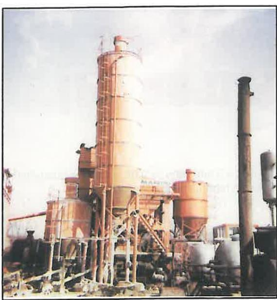
Fig. 9 Baza de producție Pecica: Instalația pentru producerea mixturilor asfaltice, tip MARINI
